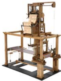
Jean Marin (fabricant), Modèle réduit de métier à mécanique Jacquard pour façonné, perfectionné en 1817 par Skola, avant 1863, bois, plomb, taffetas broché
